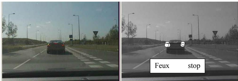
Figure 82 : détection de feux stop
