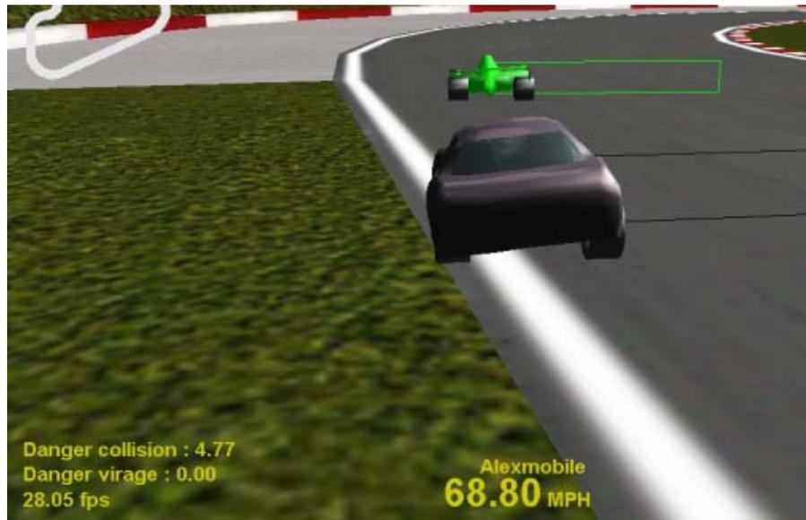
**Figure 49 :** Suivi de véhicule présentant peu de risques de collision : temps de réaction autorisé = 4.77s
