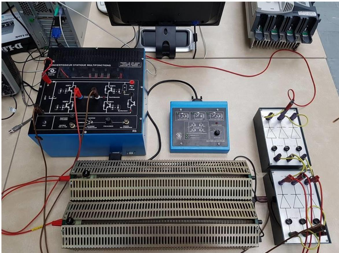
Nous avons remarqué que la valeur de la résistance avait un impact direct sur le couple et sur l'intensité de cette dernière. En choisissant une résistance de 1ohm on limite le courant à 15A.
