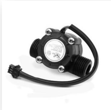
Le débitmètre d'eau consiste à mesurer la quantité d'eau consommée par l'utilisateur. Lorsque l'eau circule à travers la pale qui lui va tourner par l'action de l'eau, il y aura donc conversion d'énergie hydraulique en énergie électrique.
