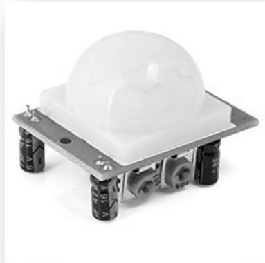
Le capteur de mouvement permet de détecter un mouvement dans son champ de vision en se basant sur l'infrarouge. On parle aussi de capteur Pyroélectrique ou PIR.
