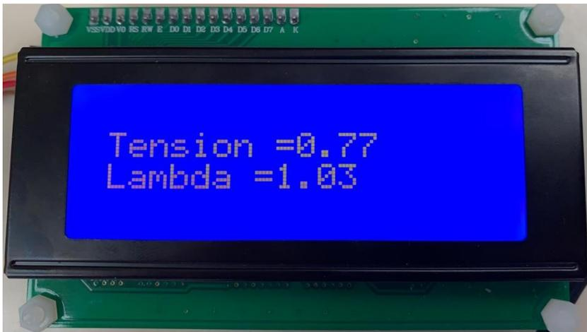
En fonctionnement normal pour mesurer la tension d'une sonde lambda on doit mesurer directement sur les bornes de la sonde. Pour simuler cette sonde nous avons choisi de simuler celle-ci via un potentiomètre qui simule la tension du signal.
