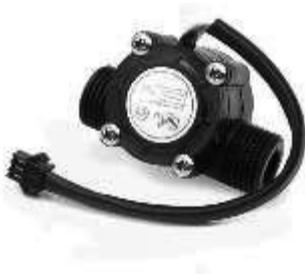
Le débitmètre d'eau consiste à mesurer la quantité d'eau consommée par l'utilisateur. Lorsque l'eau circule à travers la pale qui lui va tourner par l'action de l'eau, il y aura donc conversion d'énergie hydraulique en énergie électrique.
