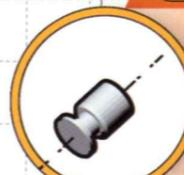
**Le capteur d'angle volant** analyse l'information donnée par le conducteur à l'aide de laquelle il calcule la trajectoire souhaitée par ce dernier.
