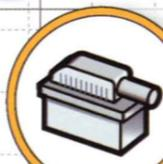
**Le calculateur** reçoit des informations d'accélération transversale, de vitesse de lacet (ou moment de rotation : mouvement de rotation latérale du véhicule par rapport à son centre, contribue à modifier la position du véhicule par rapport à sa direction de déplacement) et de vitesse du véhicule.
