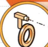
**Le capteur de vitesse de rotation** est affecté à chacune des roues du véhicule. Il mesure constamment la vitesse de rotation de chaque roue et transmet l'information au calculateur central du système ESP.
