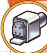
**Le groupe hydraulique ESP** intègre un calculateur. Il réceptionne les informations des différents capteurs. Il envoie des instructions au système de freinage sur lesquelles une pression est calculée très précisément. Il peut également agir sur le couple moteur.
