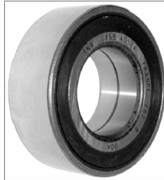
La piste magnétique ou joint codeur se situe du côté des repères de fabrication du roulement de roue.
