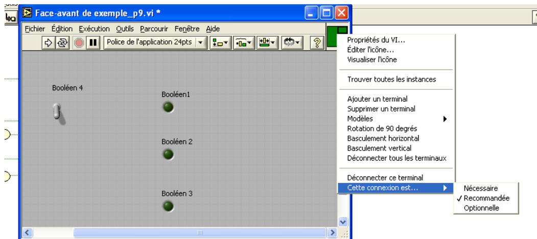
Pour les terminaux d'entrée, **Nécessaire** signifie que le diagramme bloc de la face arrière dans lequel est implanté le sous-VI sera rompu si l'entrée nécessaire n'est pas câblée. **Nécessaire** n'est pas disponible pour les terminaux de sortie.
