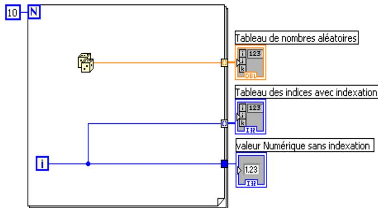
Dans l'exemple ci-dessus, on voit que les bornes de sorties sont de types. Lorsque celles-ci sont pleines, se sont des bornes standard. La valeur renvoyée en sortie de la boucle For est la dernière valeur stockée dans le terminal. Dans ce cas là, il n'y a pas ce que l'on appelle « indexation ».
