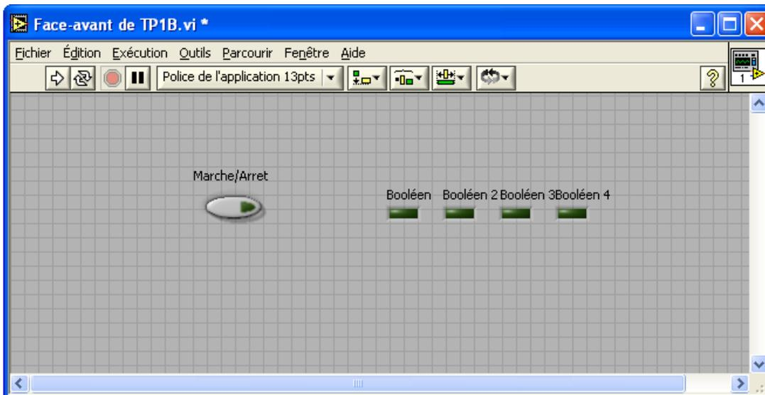
La face avant est l'interface utilisateur du VI. Vous allez créer la face avant avec les contrôles (entrées) et les indicateurs (sorties) qui sont les entrées et les sorties du VI qui vont interagir avec l'utilisateur.
