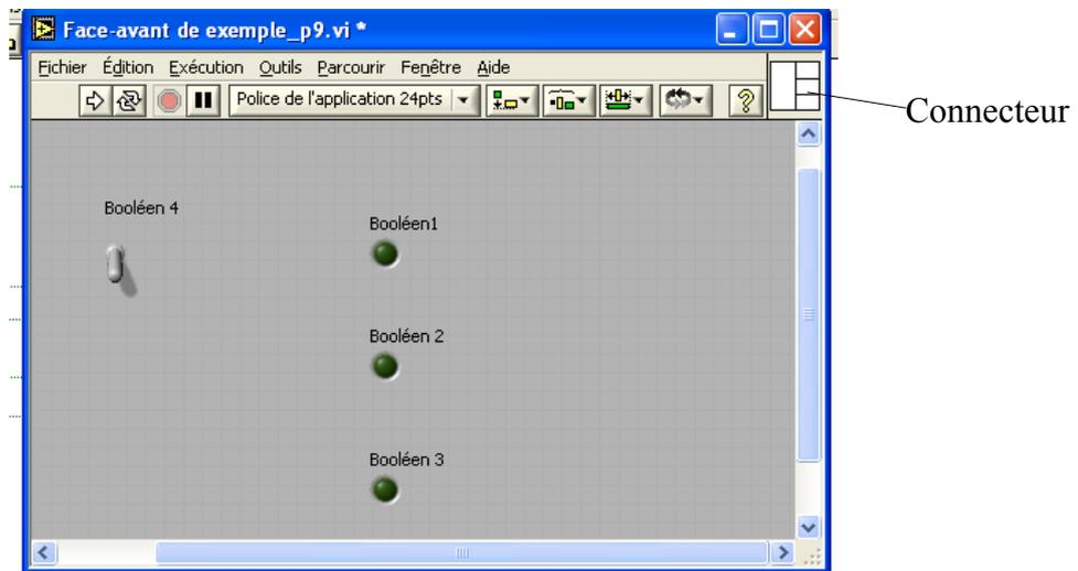
Le schéma des connecteurs peut avoir au plus 28 terminaux. Si vous utilisez sur votre face avant plus de 28 contrôles et terminaux, vous devrez les regrouper en créant des clusters et assigner ces clusters à un terminal du schéma des connexions.
