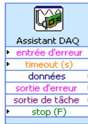
On voit notamment en sortie, une sortie d'erreur si la tâche s'est mal exécutée, les données. En entrée, on pourra avoir : un timeout au delà duquel on estime que la tâche a échoué et une entrée STOP puisque ici on est configuré en acquisition continue. Dans les autres modes d'acquisition cette entrée n'existe pas.
