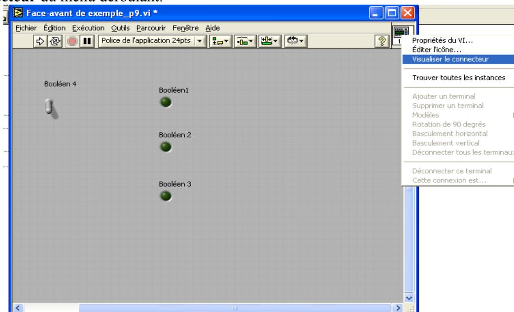
Le schéma des connecteurs remplace l'icône. Chaque rectangle du schéma des connecteurs représente un terminal. Utilisez les rectangles pour fixer les entrées et les sorties. Le nombre de terminaux que LabVIEW affiche sur le schéma des connecteurs dépend du nombre de contrôles et d'indicateurs situés sur la face avant. Par exemple ici, nous en avons quatre.
