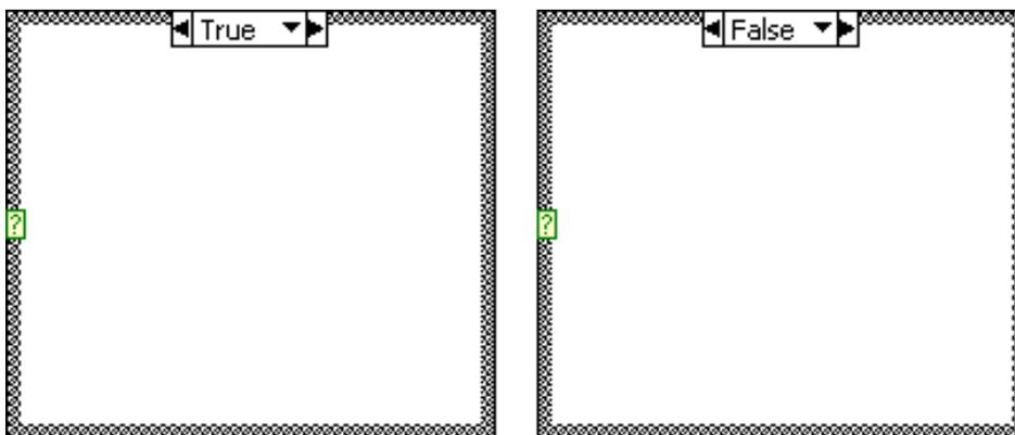
Une structure de type Case possède au moins deux sous-diagrammes. Seulement l'un d'entre eux est visible à la fois et la structure n'en exécute qu'un seul à la fois. Une donnée en entrée (?) détermine lequel des sous-diagrammes va s'exécuter.
