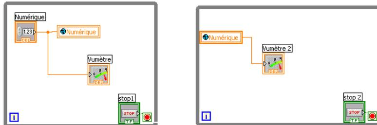
On peut ici utiliser avantageusement des variables globales. Pour en placer une faire : **Fonctions >> Structures >> Glob.** Vous verrez apparaître l'icône suivant :
