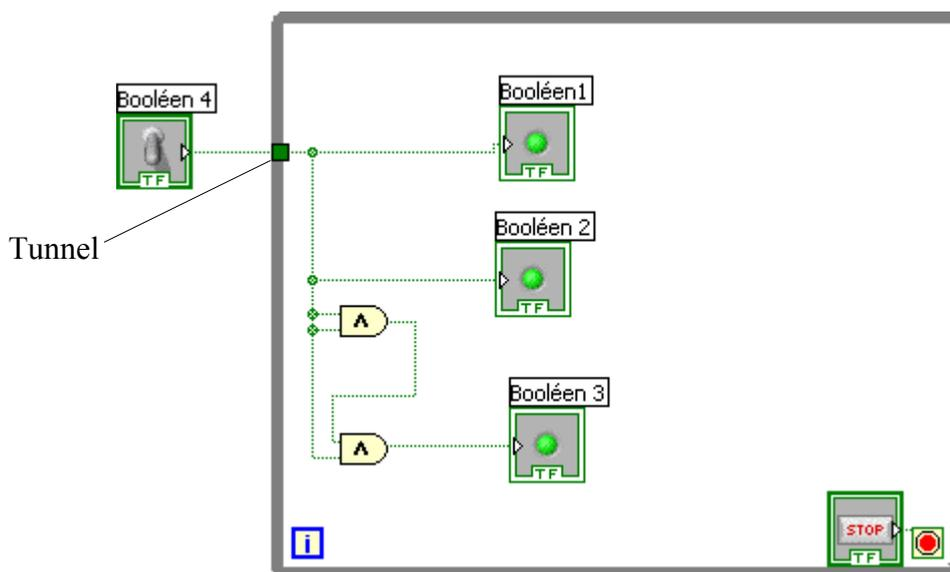
Vous allez utiliser les structures situées dans la palette **FUNCTION – STRUCTURES** pour contrôler comment un diagramme va s'exécuter.
