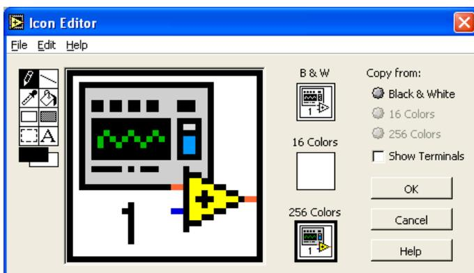
Chaque VI montre une icône dans le coin supérieur droit de la face avant et dans le diagramme de face arrière. Une icône est une représentation graphique d'un VI. Il peut contenir du texte, des images ou une combinaison des deux. Si vous utilisez un VI comme un sous-VI, l'icône permet d'identifier le sous-VI à l'intérieur du diagramme de face arrière.
