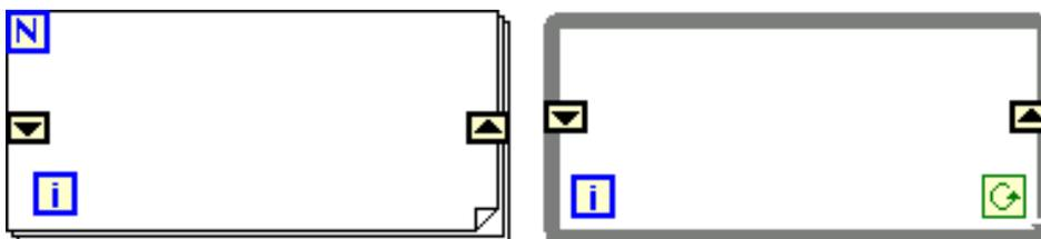
On peut utiliser des registres à décalage pour transférer des valeurs d'une itération à la suivante dans le cas des boucles For et While. C'est l'équivalent des variables locales à une boucle dans le cas de la programmation C.
