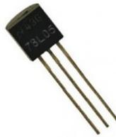
Il permet de transformer du 12 V continue en 5 V continue, ceci permet au système embarqué d'être autonome.
