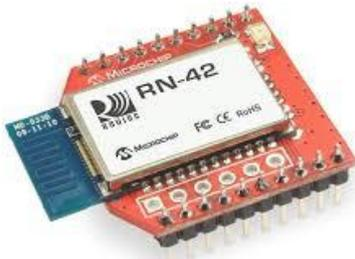
Les modules HC-0X et RN-42XV utilisent le protocole SPP (Serial Port Profile) qui permet à un appareil connecté en Bluetooth au module de le considérer comme un port série classique (COM X).
