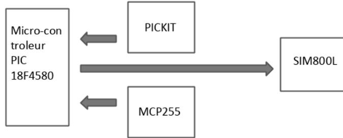
Voilà le schéma synoptique qui explique l'objectif de cette assemblage et la réalisation des tests.
